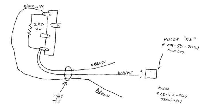
BROWN WIRE IS 72" LONG, 22 GAUGE STRANGED ORANGE WIRE IS 42" LONG, 22 GAUGE STRANGED WHITE WIRE IS 62" LONG, 22 GAUGE STRANGED
